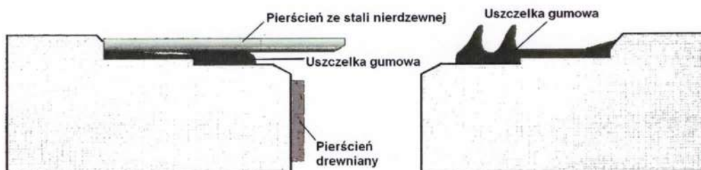
Rys. 1. Łącznik rur kanalizacyjnych z polimerobetonu układanych metodą przeciskową, stosowany dla rur o średnicach nominalnych DN 800
